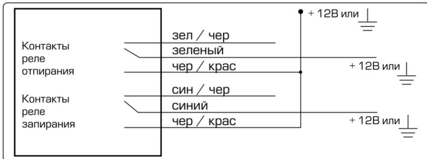
Схема подключения к двухпроводным приводам системы запираения
