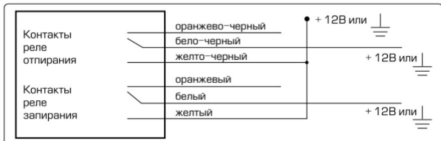
*Схема подключения к двухпроводным приводам системы запирания*
